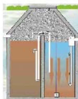
Phase 3 Ruhe-/Absetzphase (Belebtschlamm setzt sich am Boden ab, Klarwasserzone bildet sich)
